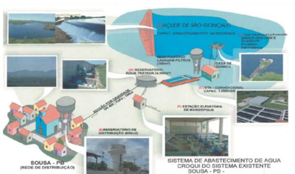
Figura 13 - Croqui do sistema de abastecimento de água
