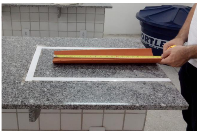
Figura 16: Medição do comprimento efetivo ( C_e ).
