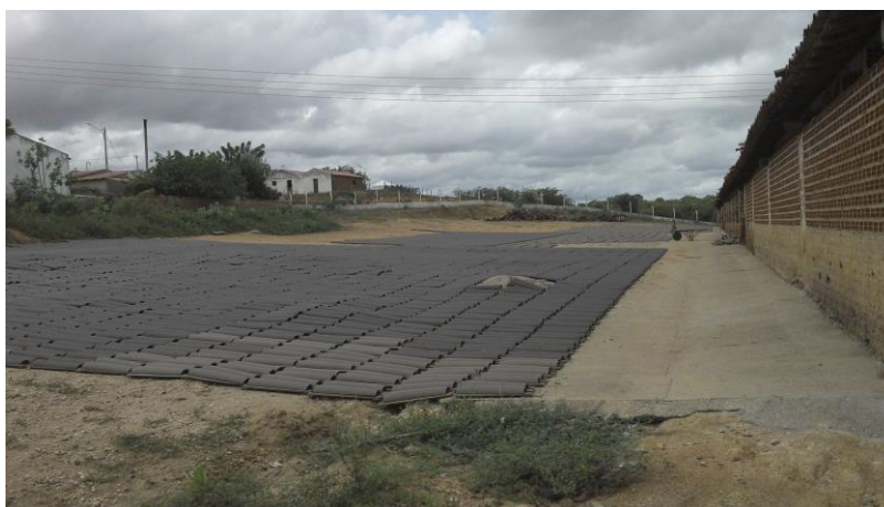
Figura 11: Secagem ao ar livre na indústria da cidade de Apodi/RN.
