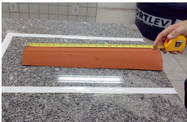
Figura 18: Medição da posição do pino ( L_p ).
