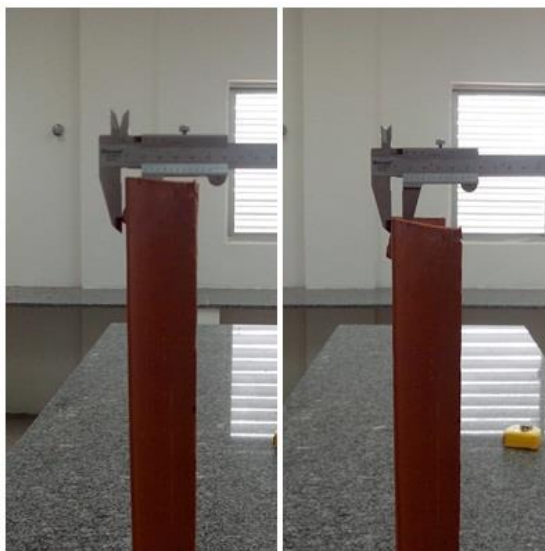
Figura 19: Medição da altura do pino ( A_p ).
