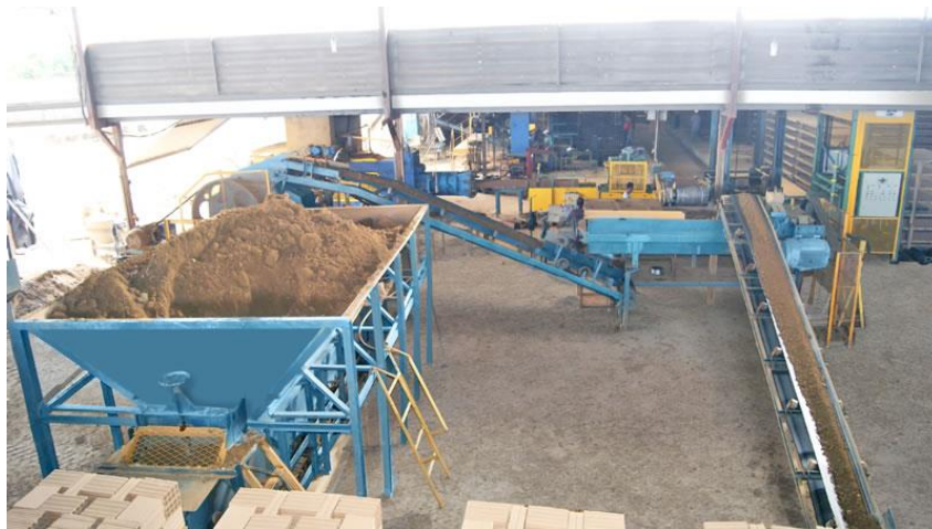
Figura 7: Preparação da matéria-prima.
