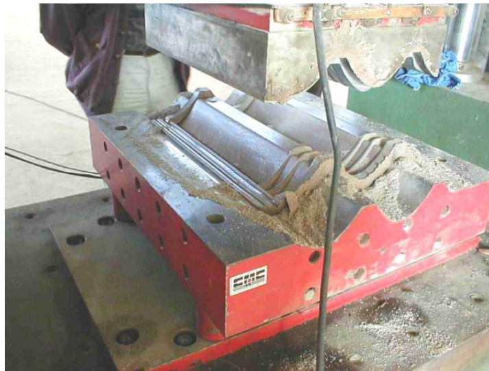
Figura 10: Prensa utilizada na fabricação de telhas cerâmicas.
