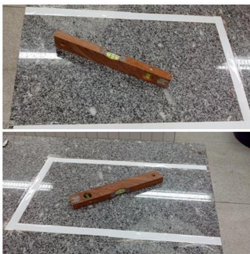
Figura 15: Determinação da superfície plana utilizada no ensaio de planaridade.
