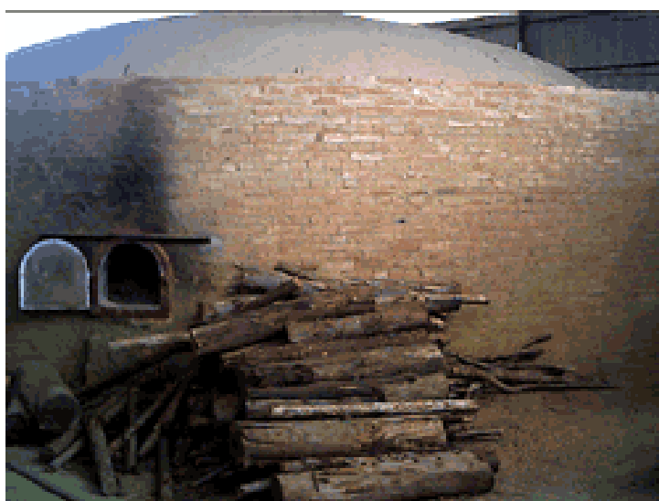
Figura 12: Queima de cerâmica em forno tipo abóboda.
