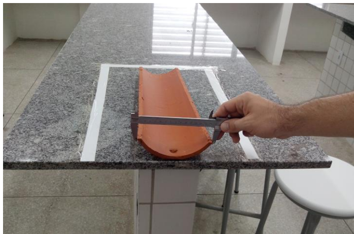
Figura 17: Medição da largura efetiva ( L_e ).
