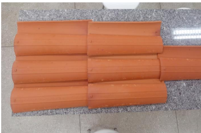
Figura 22: Telhas ajustadas para o ensaio de rendimento médio.
