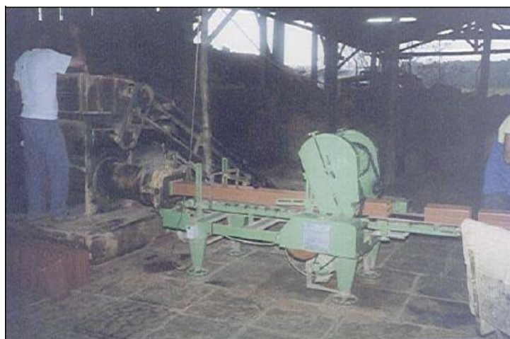
Figura 9: Máquina utilizada no corte de materiais cerâmicos logo após a extrusão.
