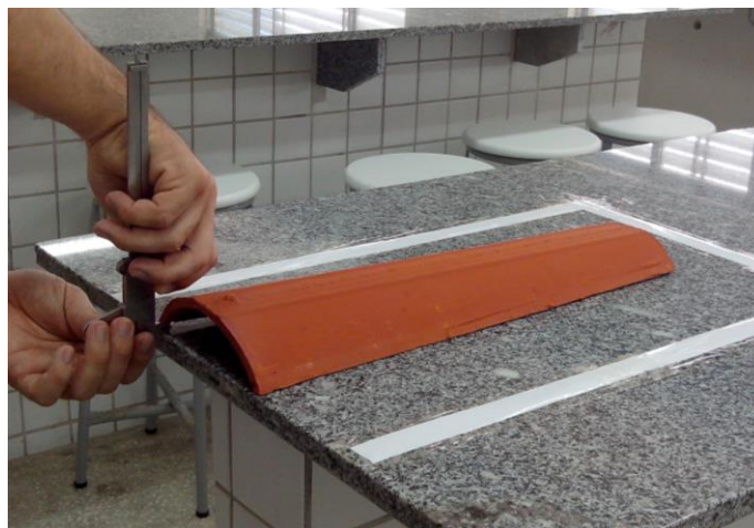
Figura 20: Medição da planaridade (PI).
