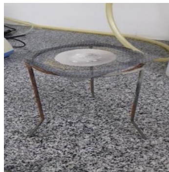
Figura 7b Tripé com tela de amianto
