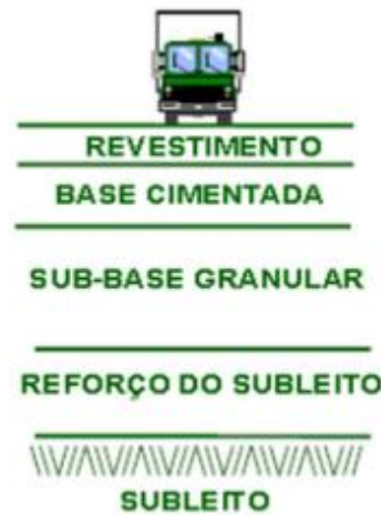
Figura 2 - Camadas de um pavimento semirrígido
