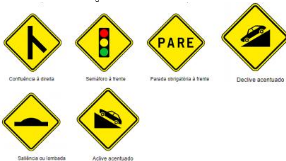
Figura 06 – Placas de advertência.
