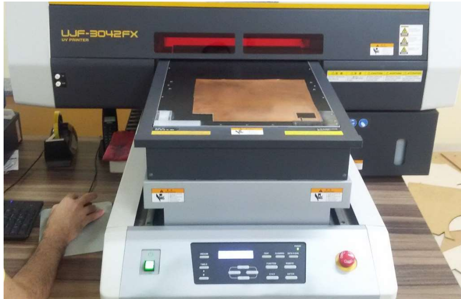
Figura 36 - Processo de plotagem em uma placa de FR4.
