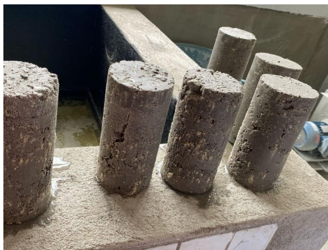
Figura 10 - Corpos de prova com bagaço do sorgo
