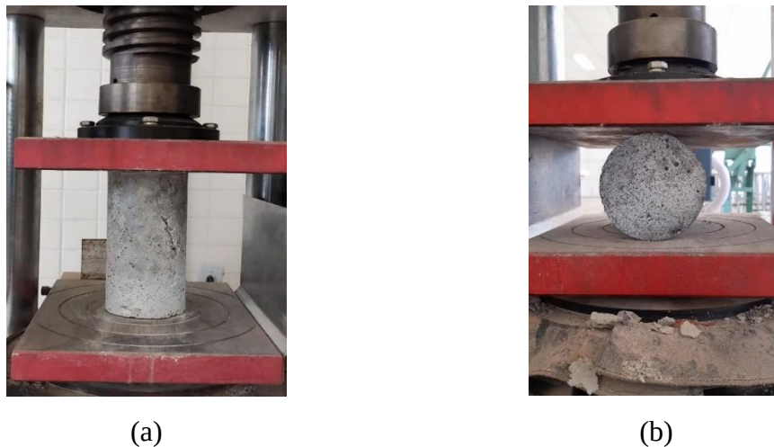
Figura 7 - Resistência à compressão (a) e resistência à tração por compressão diametral (b)
