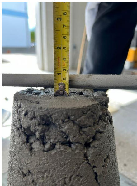
Figura 9 - Abatimento do concreto
