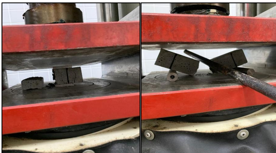
Figura 19: Ensaio de resistência à compressão (a), tração na flexão (b).
