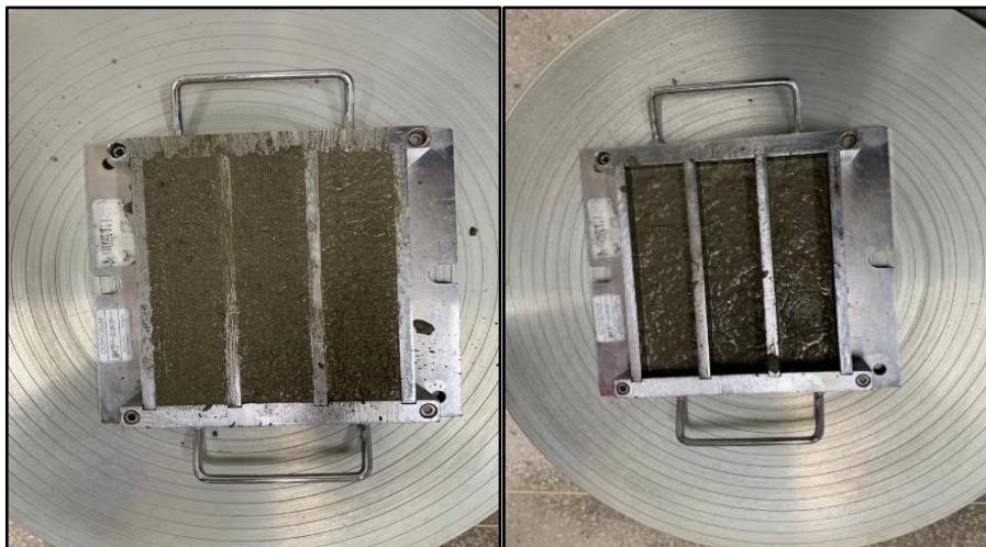
Figura 18: Moldagem dos corpos de prova prismáticos.
