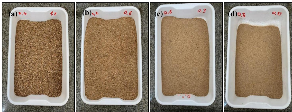
Figura 10: Areia natural fracionada.
