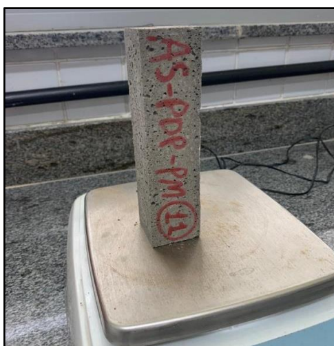
Figura 20: Ensaio de densidade de massa no estado endurecido.
