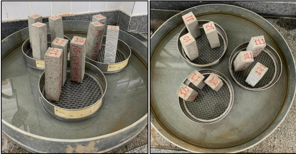
Figura 21: Ensaio de absorção de água por capilaridade.
