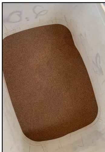
Figura 13: Pó de madeira passante na peneira de 0,15 milímetros.
