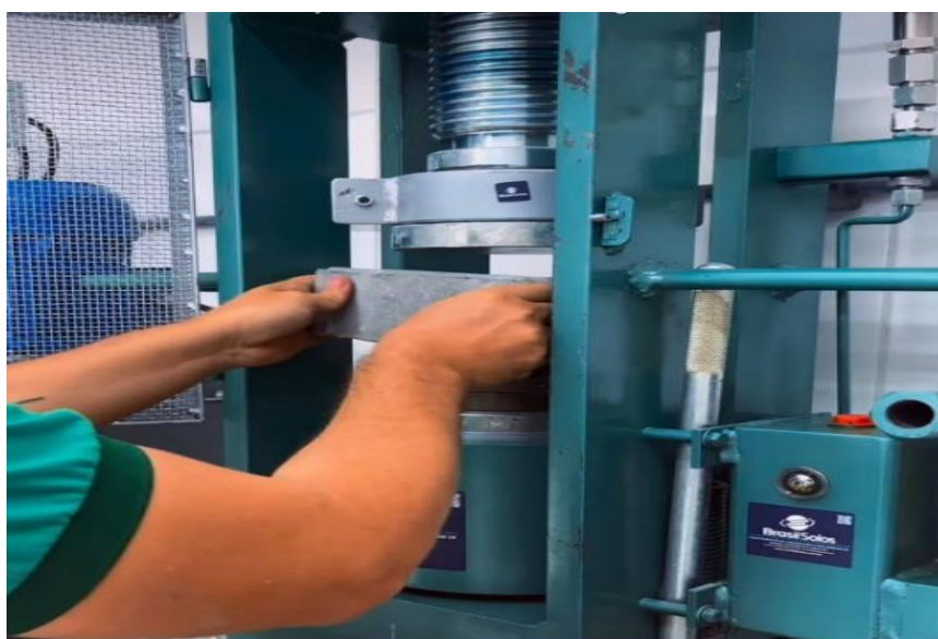
Figura 26 - Colocação do bloco na prensa hidráulica
