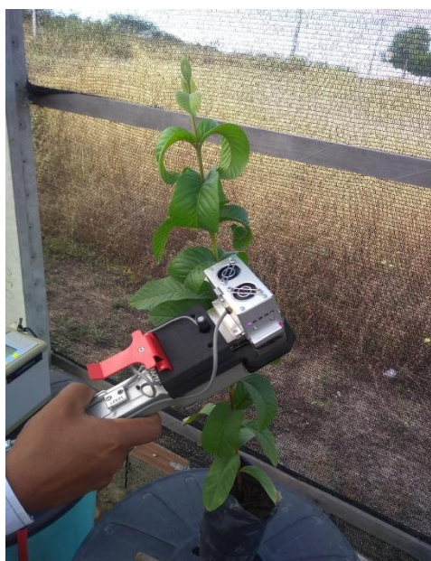
Figura 5. Análise das trocas gasosas foliares com auxílio do equipamento IRGA, modelo LCPro+ ADC BioScientific Ltda aos 125 DAS.
