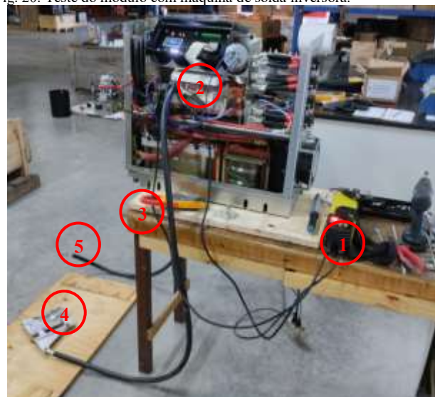
Fig. 20. Teste do módulo com máquina de solda inversora.
