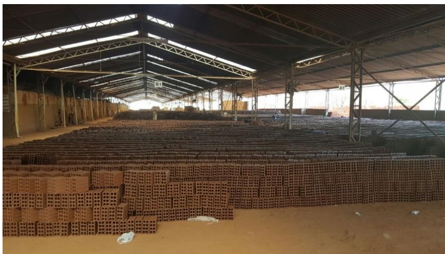
Figura 04 – Processo de Secagem dos Blocos Cerâmicos.
