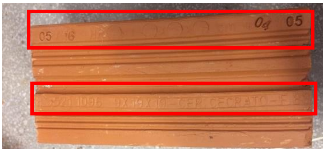
Figura 18 – Identificação da empresa C nos blocos cerâmicos.
