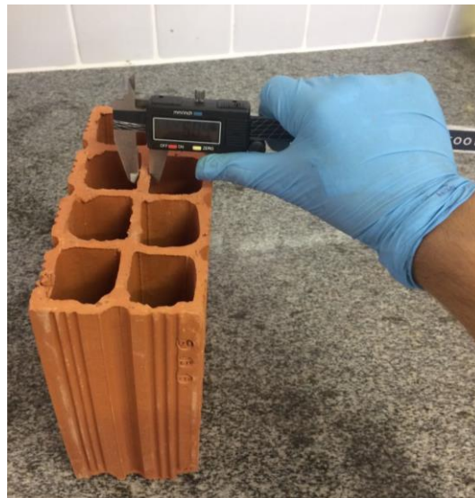
Figura 11 – Medição das paredes e septos dos blocos cerâmicos.
