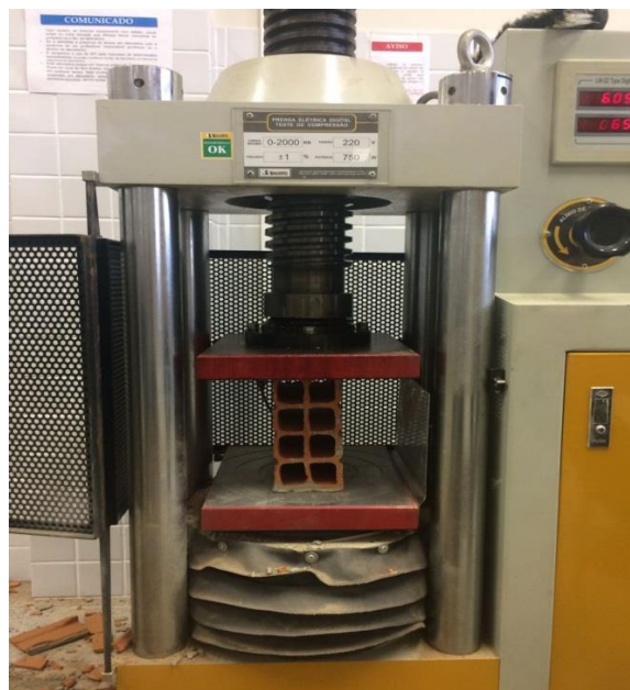
Figura 15 – Ensaio de compressão nos blocos cerâmicos.
