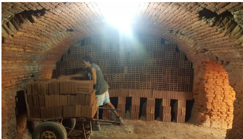
Figura 05 – Processo de Queima dos Blocos Cerâmicos.
