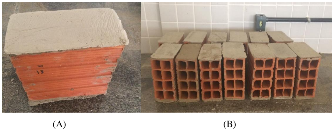
Figura 14 – (A) Amostra de um bloco cerâmico capeado; (B) Grupo de amostras preparadas para ensaio.
