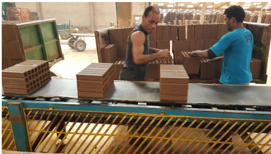
Figura 06 – Controle de Qualidade dos Blocos Cerâmicos.
