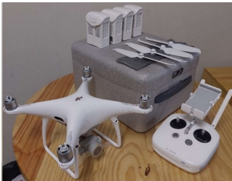
Figura 9 - VANT modelo Phantom 4 PRO utilizado no levantamento aerofotogramétrico.
