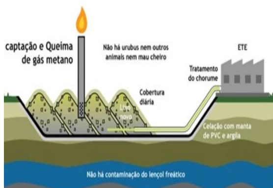
Figura 14 – Desenho de um Aterro Sanitário
