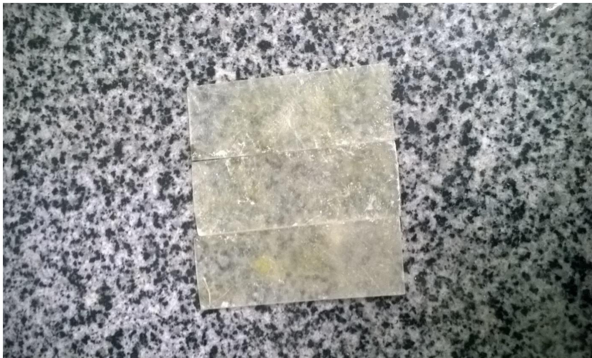
Figura 22: Compósitos com três camadas de manta
