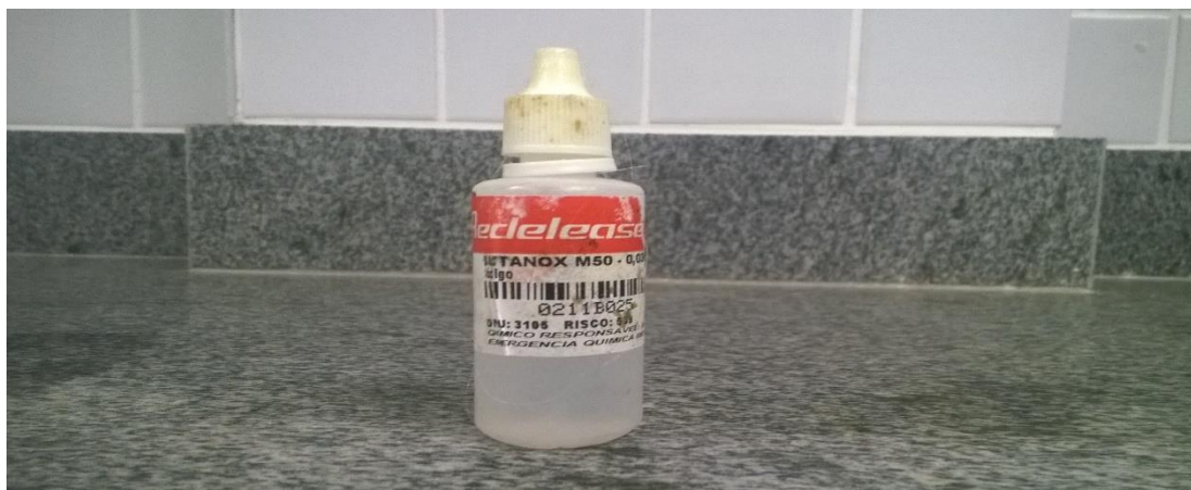
Figura 6: Catalisador usado para diminuir o tempo de cura
