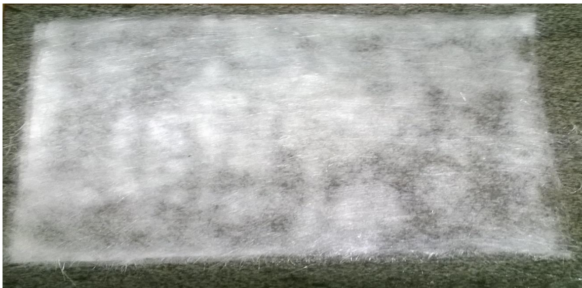
Figura 3: Compósito fabricado pelo modo hand lay-up
