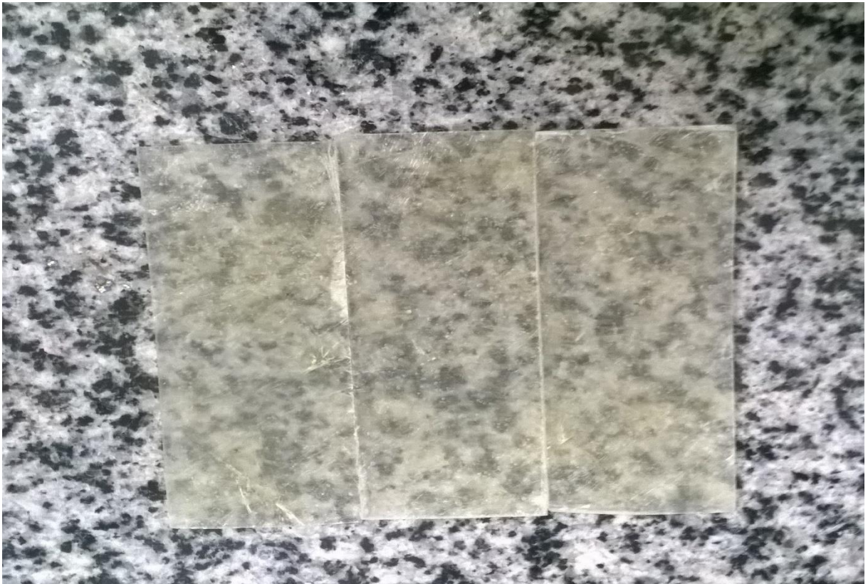
Figura 20: Compósitos com duas mantas de fibra de vidro
