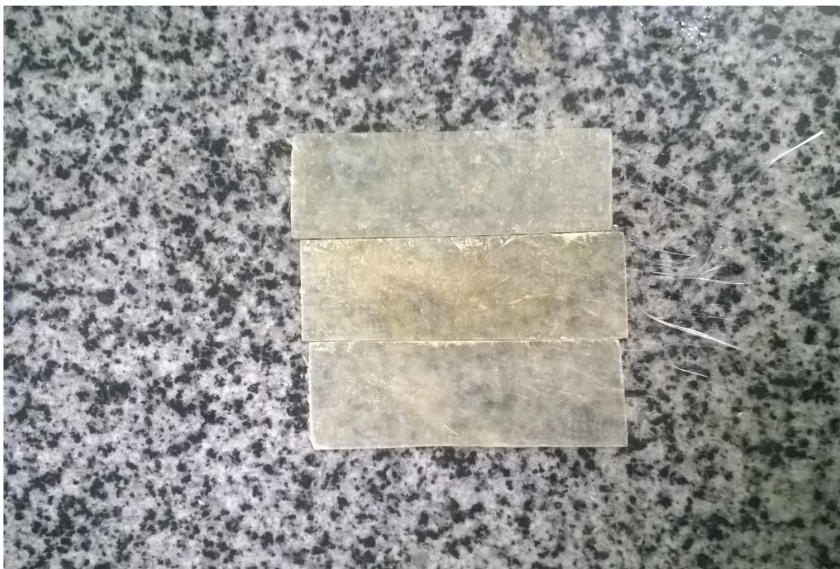
Figura 21: Compósitos com duas camadas de manta e uma de tecido
