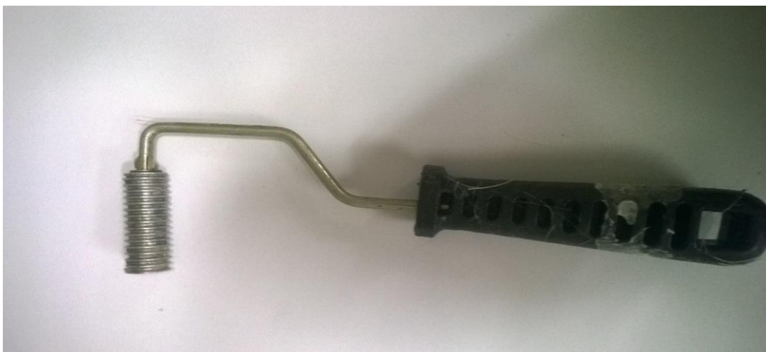
Figura 9: Rolo usado para espalhar a resina
