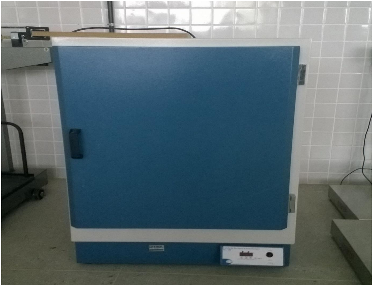
Figura 23: Estufa usada na secagem dos corpos de prova
