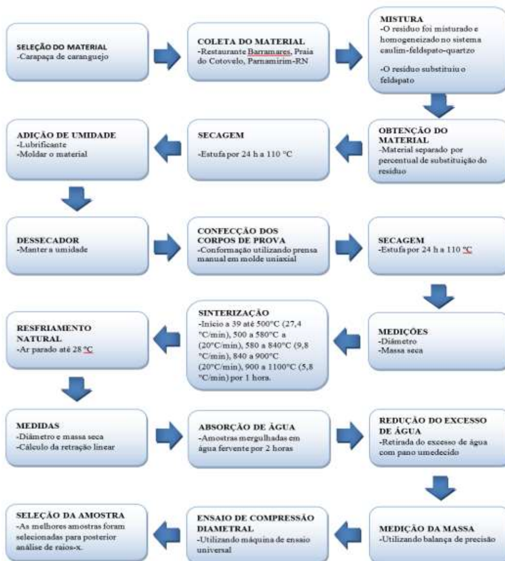
Figura 6 - Fluxograma do processo experimental do trabalho.
