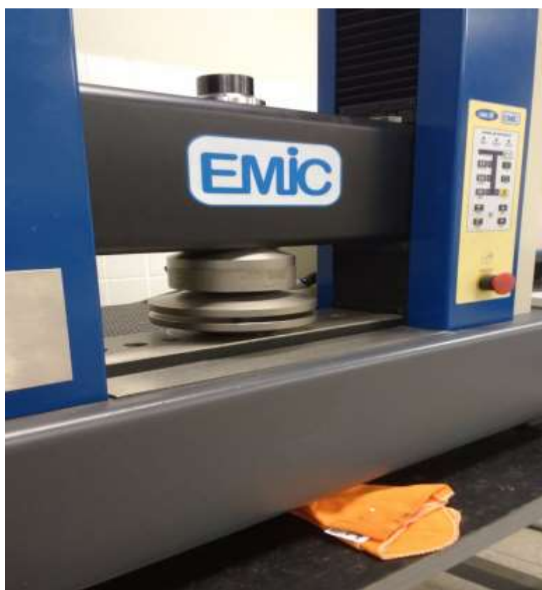
Figura 12 - Processo de compressão diametral.
