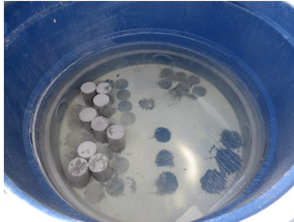
Figura 27 - Processo de cura dos corpos-de-prova.
