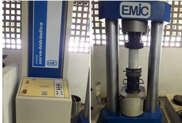
Figura 29 - Prensa hidráulica utilizada para romper os corpos-de-prova.
