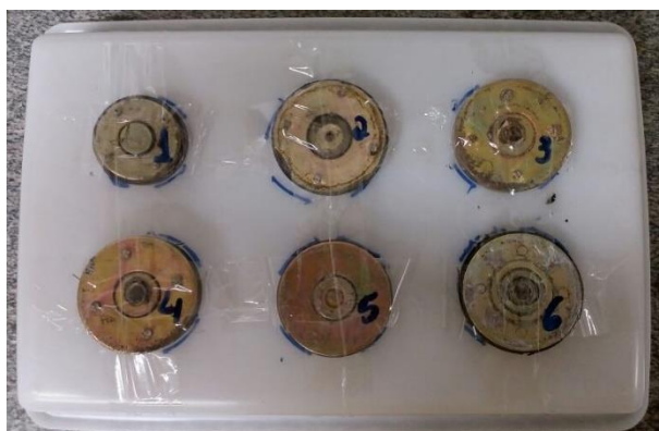
Figura 22 - Disposição dos ímãs de ferrite no fundo do recipiente.
