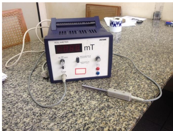
Figura 20 - Teslômetro utilizado na pesquisa.
