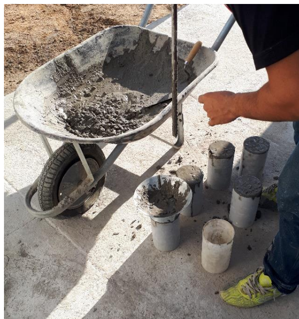
Figura 26 - Processo de moldagem dos corpos-de-prova.
