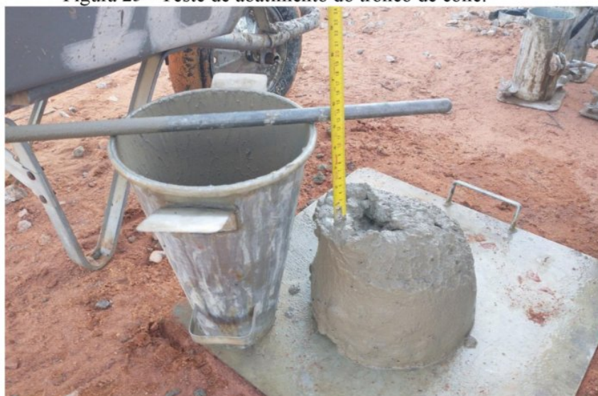
Figura 25 - Teste de abatimento do tronco de cone.
