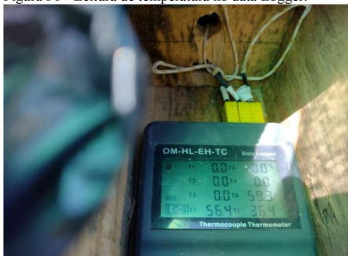
Figura 31 - Leitura de temperatura no data Logger.
