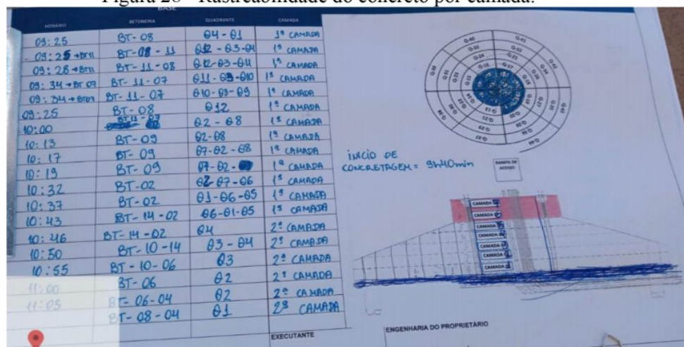
Figura 28 - Rastreabilidade do concreto por camada.
