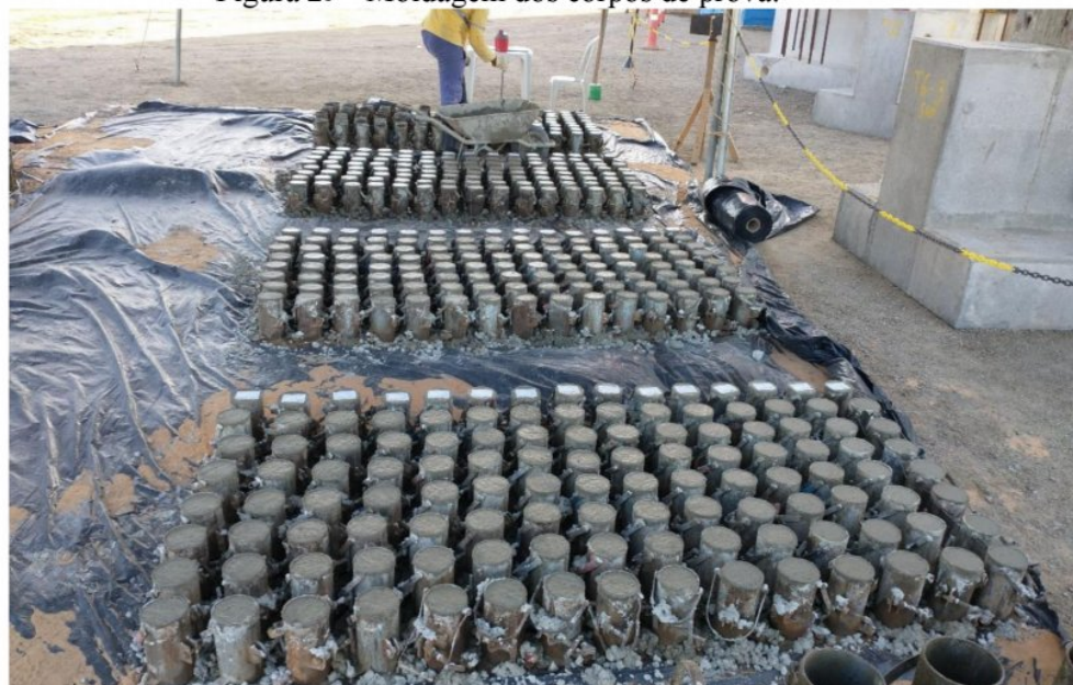
Figura 29 - Moldagem dos corpos de prova.
