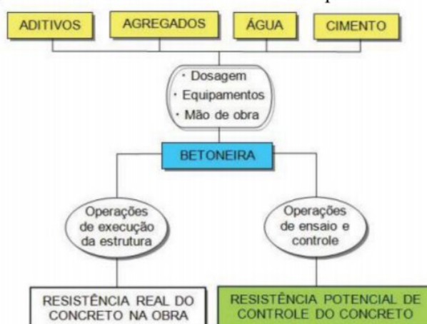
Figura 7 - Paralelo entre resistência real e potencial.
