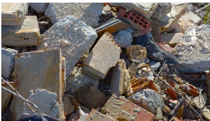
Figura 1 - Resíduos de construção civil
