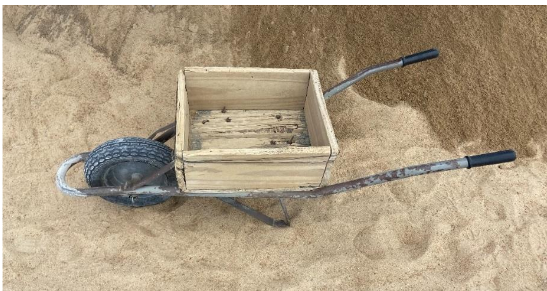
Figura 25: Padiola para dosagem de areia e brita.
