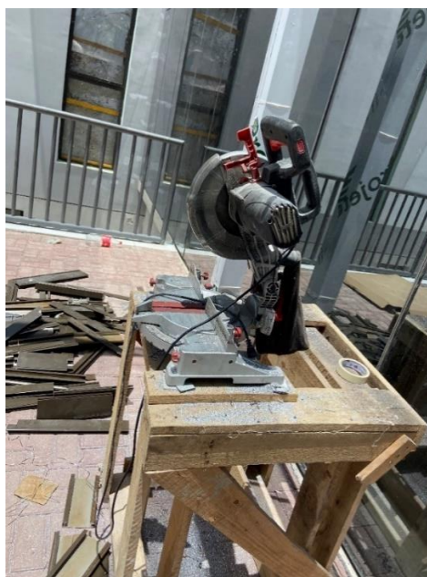
Figura 34: Serra circular dotada de coifa.
