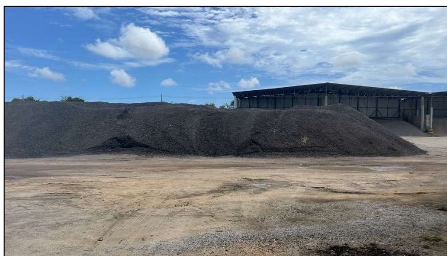
Figura 4: Estoque de RAP em Usina de CBUQ.
