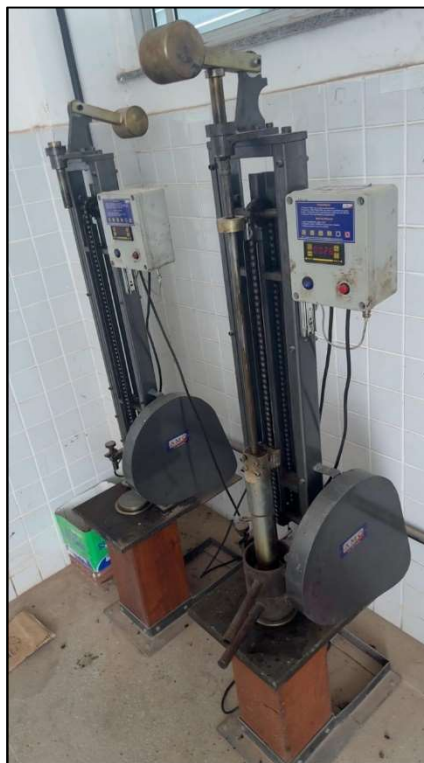
Figura 15: Compactação do corpo de prova no Compactador Marshall.
