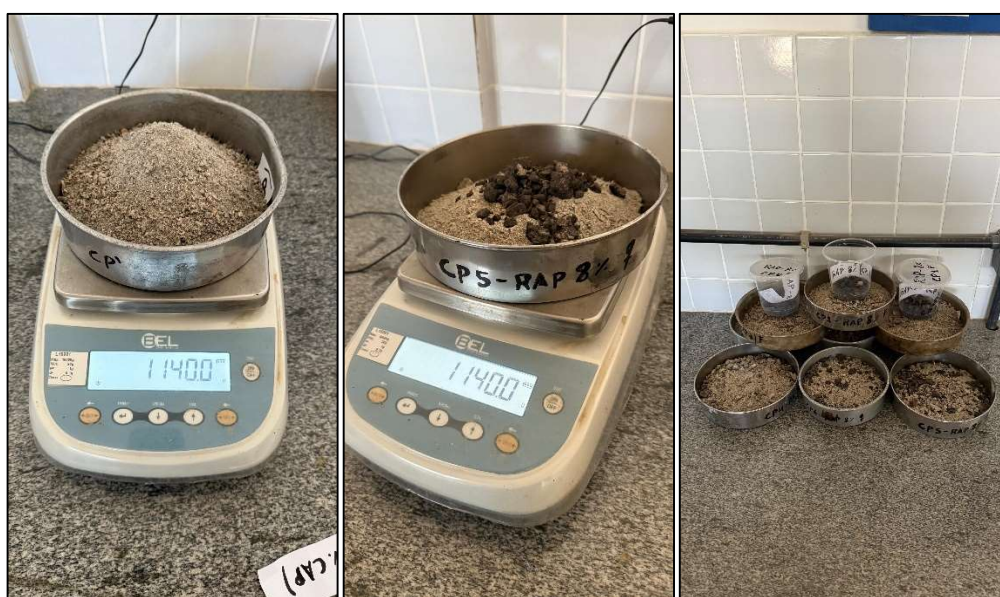
Figura 13: Pesagens e separação dos agregados das misturas asfálticas.
