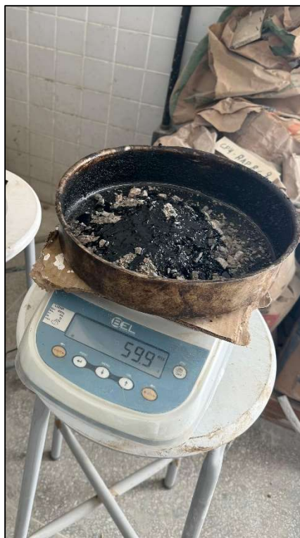
Figura 14: Incremento do teor de CAP na mistura.
