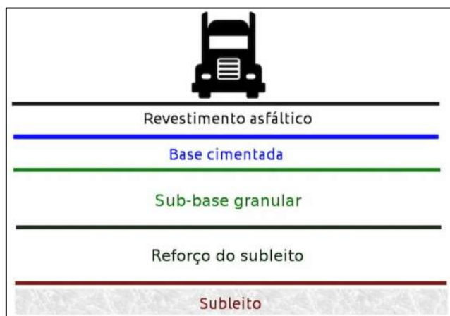
Figura 3: Estrutura típica de um Pavimento Semi-flexível
