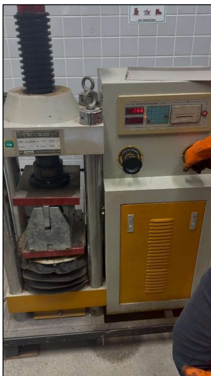
Figura 16: Ensaio de Resistência a Tração por compressão diametral.
