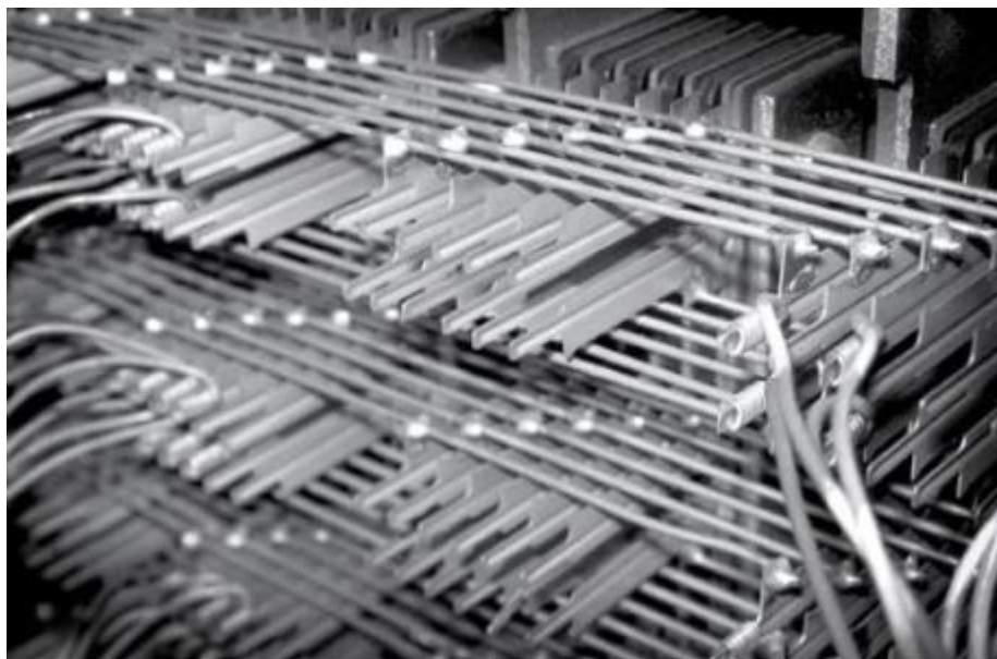
Figura 6 – Estrutura de grade da chamada comutação crossbar , usada em circuitos integrados e em placas de circuitos (notavelmente similar à estrutura neocortical).
