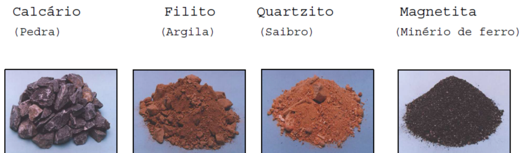
Figura 6: Alguns dos materiais que compõem o cimento.
