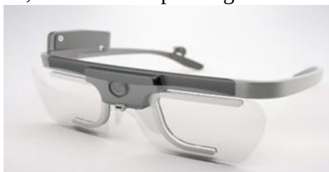
Figura 3 - Tobii Glas, óculos usado para registrar o movimento dos olhos.
