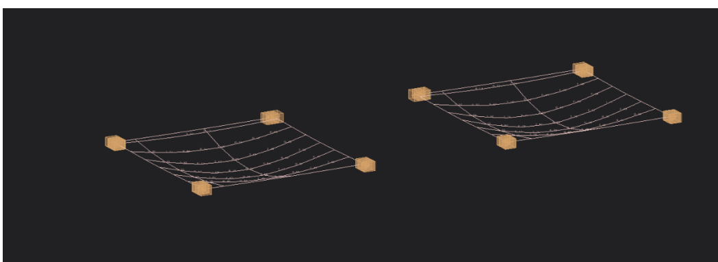
Figura 26– Deformada da grelha das lajes Treliçada do pavimento caixa d'água
