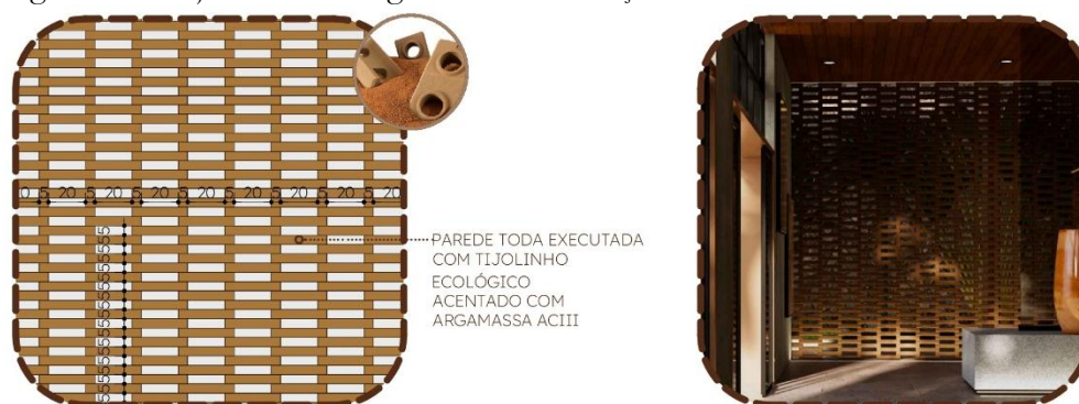
Figura 24 – Tijolinhos ecológicos e sua execução
