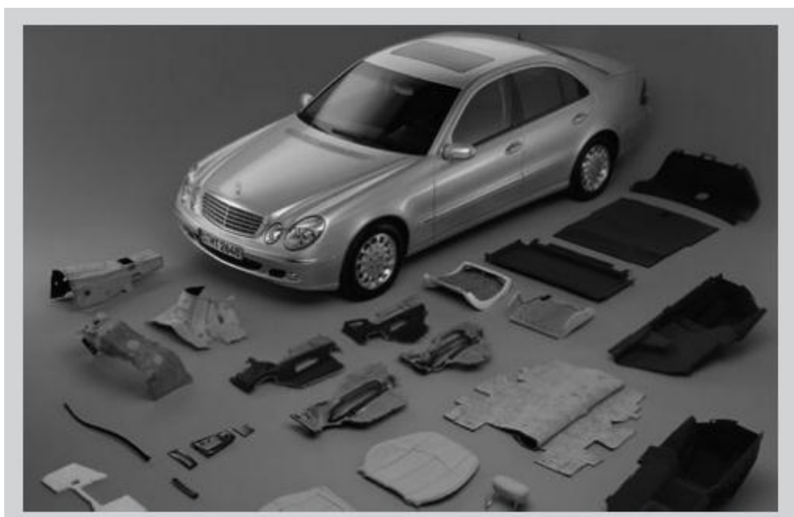
Figura 8- Fibras naturais, incluindo o sisal, na composição de peças do Mercedes Benz E-Class. Fonte: HOLBERY, 2006.
