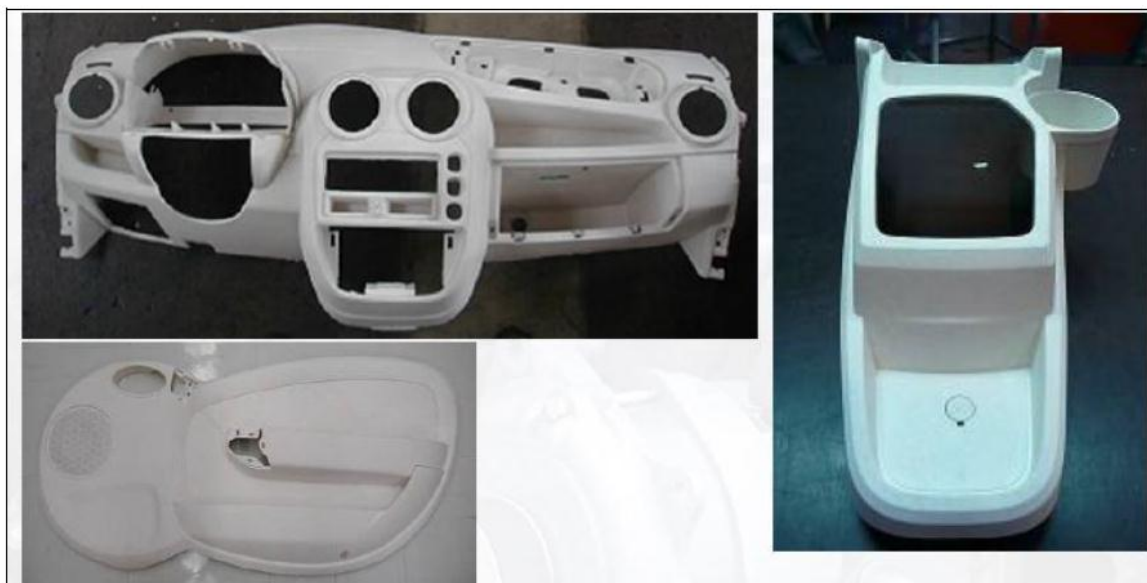
Figura 9 - Painéis de Porta, instrumentos e console central, injetados em PP/FS. Fonte: FORD MOTOR COMPANY, 2009, apud SILVA, 2010
