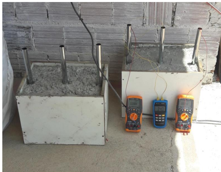
Figura 4.1: Bloco de concreto resfriado (à esquerda da imagem) e bloco de concreto de alta resistência inicial (à direita da imagem).
