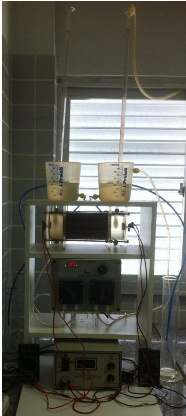
Figura 17 – Aspecto visual do reator eletrocinético.
