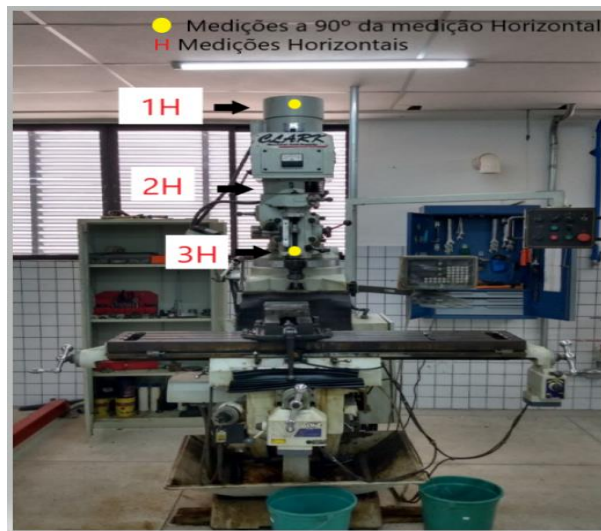
Figura 34- Identificação dos pontos de medição referentes a parte principal da fresadora ferramenteira
