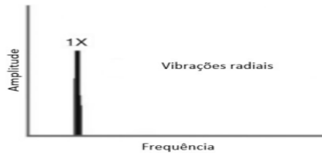
Figura 18 – Falha por folga perda de rigidez
