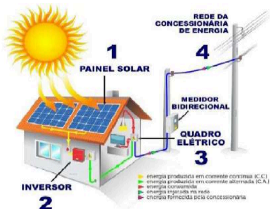
Figura 8- Instalação Fotovoltaica Completa
