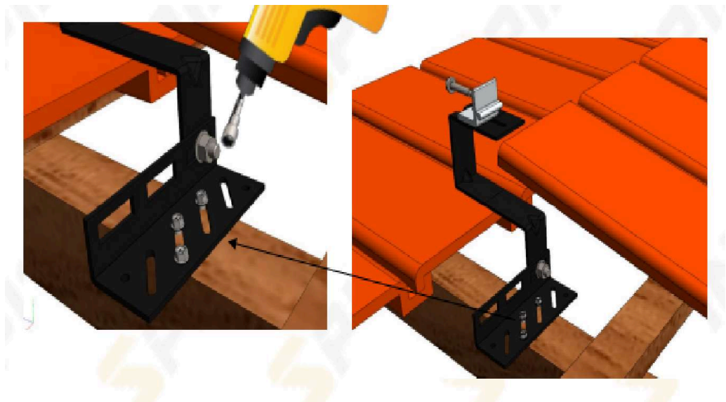
Figura 13-Fixação dos suportes para as placas solares
