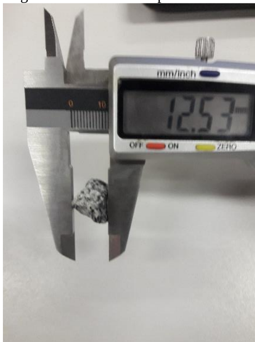
Figura 3 – Medida da espessura da brita
