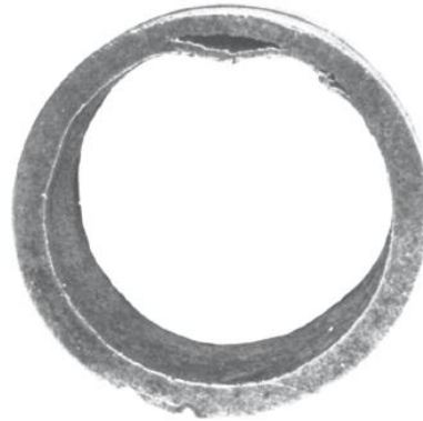
Figura 15: Tubo de aço-carbono com empolamento pelo hidrogênio, ocasionado por H_2S e água.
