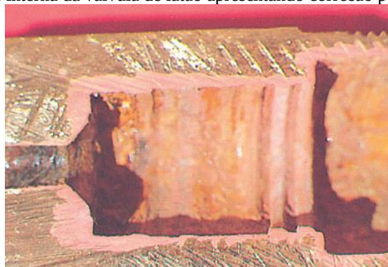
Figura 14: Parte interna da válvula de latão apresentando corrosão por dezincificação.
