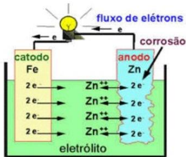
Figura 1: Pilha de corrosão eletroquímica com dois eletrodos diferentes.
