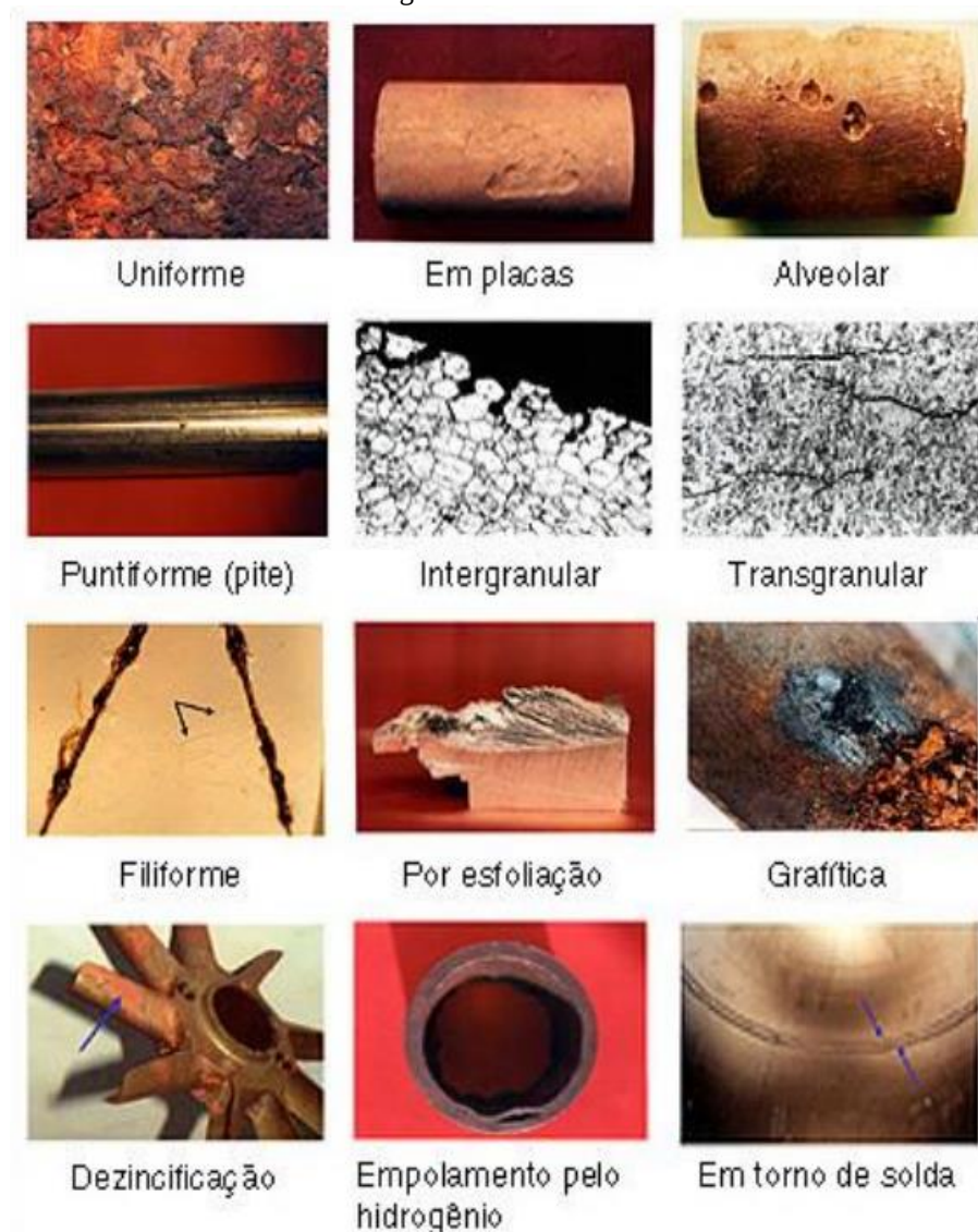
Figura 4: Formas de Corrosão.
