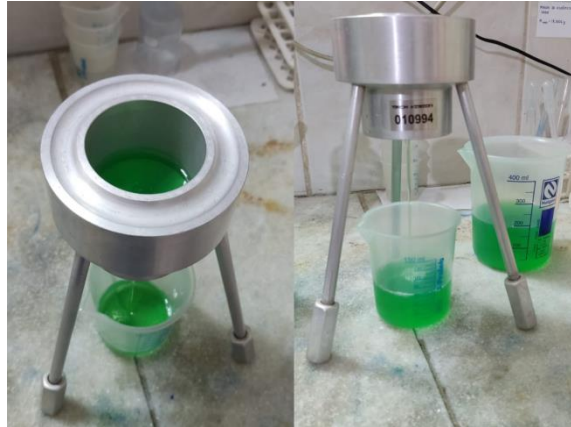
Figura 15 - Determinação da viscosidade do lava-louças limão utilizando o Copo Ford
