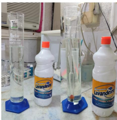
Figura 17 - Determinação do teor de cloro da água sanitária
