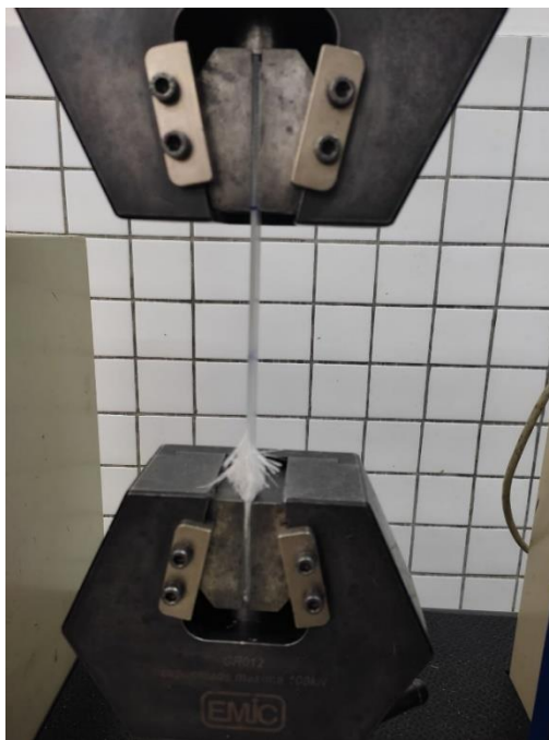
Figura 26 - Fratura do corpo de prova dentro do galgo.
