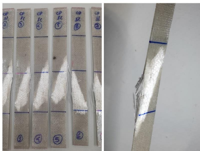
Figura 39 - Fratura no PRFV + 1,0%.
