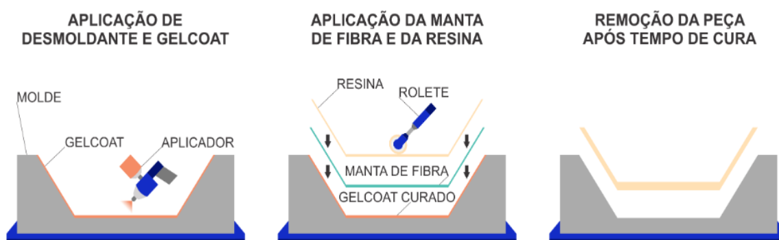
Figura 5 - Processo Hand Lay-Up .
