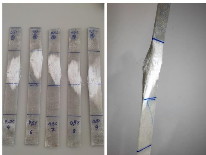
Figura 38 - Fratura no PRFV + 0,5%
