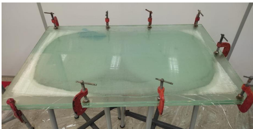
Figura 19 - Fixação do molde na matriz polimérica.
