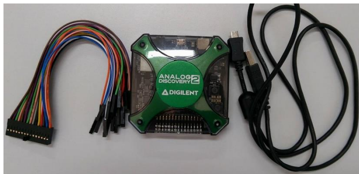
Figura 22 – Analog Discovery 2 da fabricante Digilent utilizada para realizar a conversão A/D do sinal EMG.
