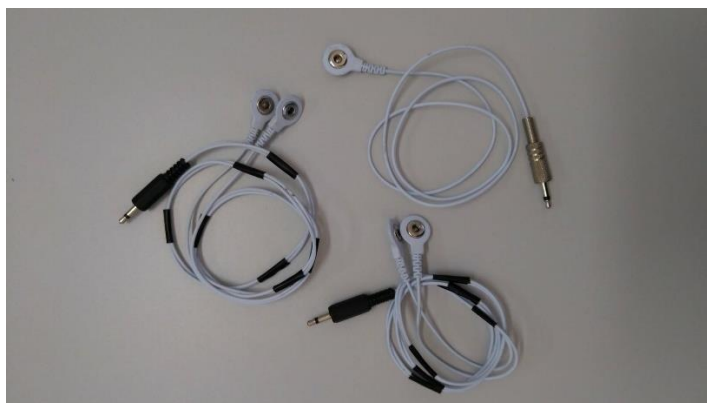
Figura 24 – Cabos blindados com terminações em P1 utilizados na aquisição do sinal EMG.
