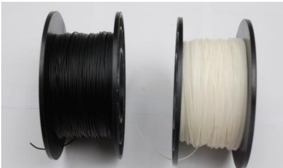
Figura 33– Filamento ABS 1,75mm utilizado para realizar a impressão das peças.
