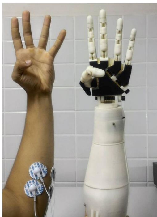
Figura 51– Prótese InMoov reproduzindo o movimento de Contração Polegar.
