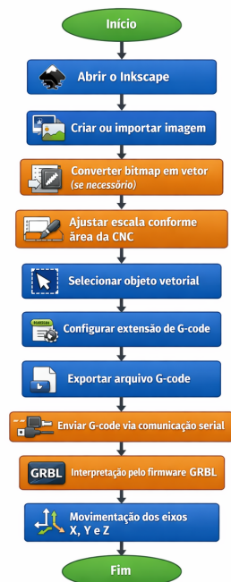
Figura 6 – Fluxograma do processo de geração do G-code
