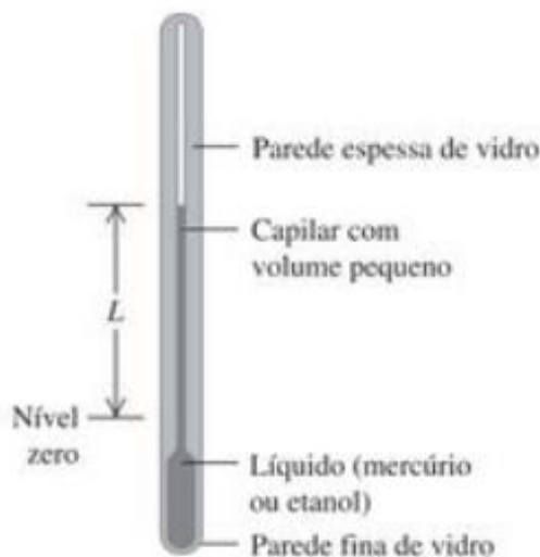
Figura 5: Representação de um sistema para medir a temperatura a base de etanol ou mercúrio
