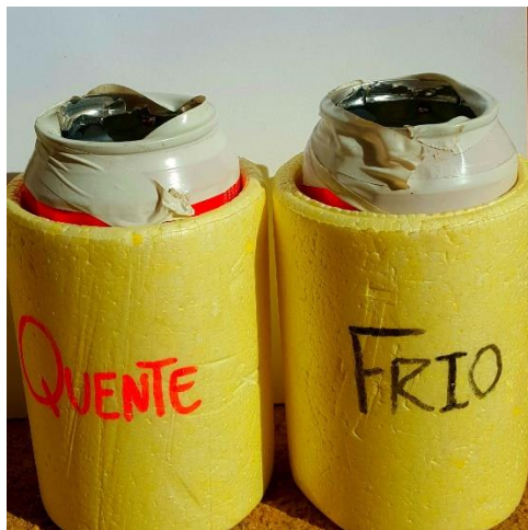
Figura 15: Recipientes abertos para comportar água quente e água gelada isolados parcialmente
