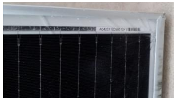
Fig 10. Módulo com frame danificado. Fonte: Autoria própria.
