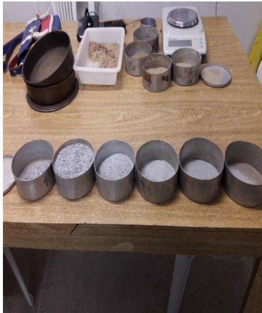
Figura 10 – Frações dos agregados após realização do ensaio de peneiramento
