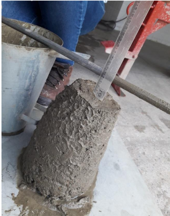
Figura 13 – medida do abatimento com o auxílio da haste e uma régua milimetrada
