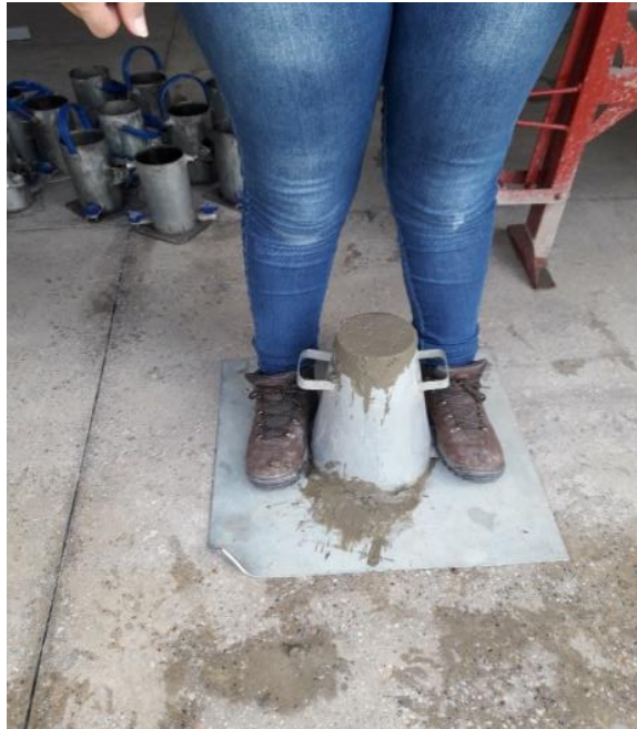
Figura 12 – Slump Test apoiado com os pés pelo operador para retirada do molde
