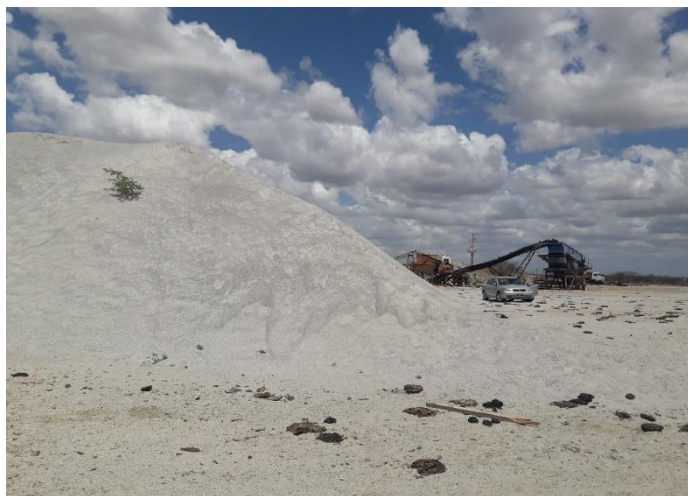
Figura 5 – Resíduo do pó de pedra estocado em pedreiras
