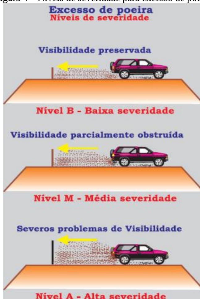
Figura 4 – Níveis de severidade para excesso de poeira
