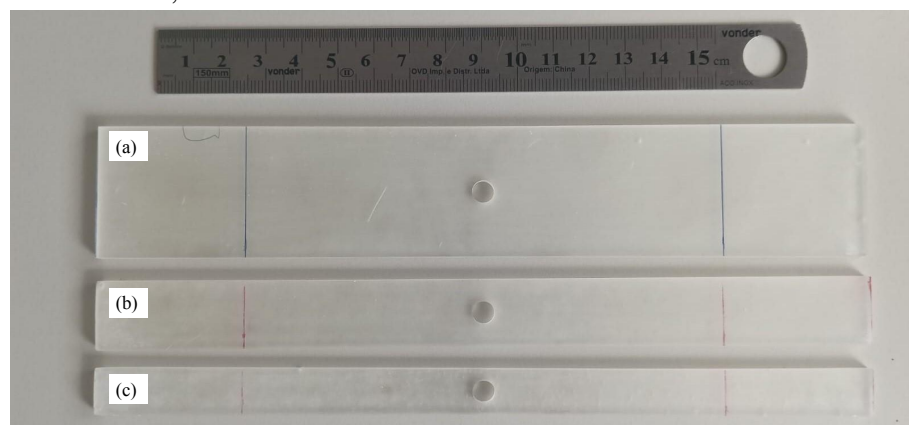
Figura 32 – Corpos de prova de resina epóxi antes da aplicação da textura: (a) Tração Resina com furo d/W=0,16 ; (b) Tração resina com furo d/W=0,33 ; (c) Tração Resina com furo d/W=0,50 .
