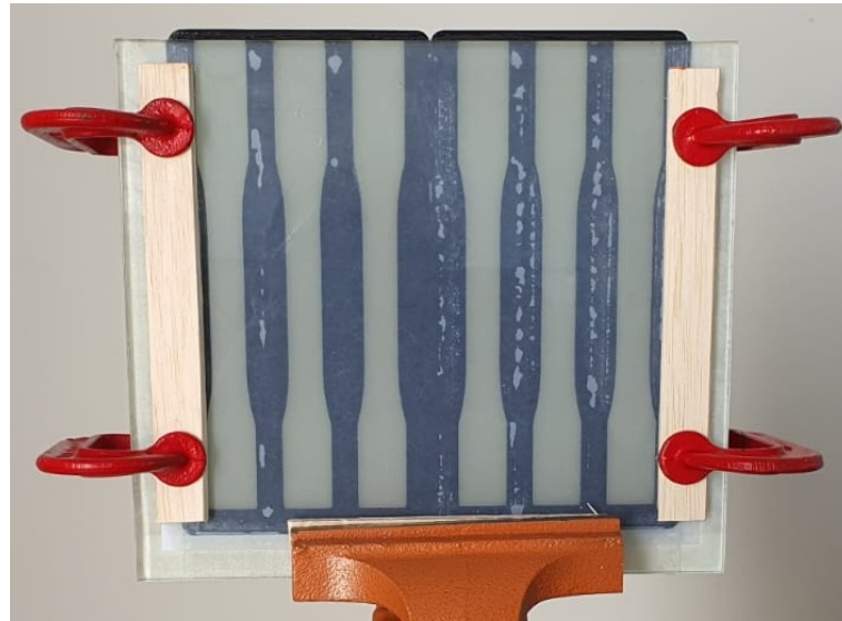
Figura 22 – Conjunto para fabricação dos CP's de Resina Epóxi
