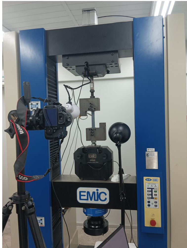
Figura 27 – Ensaio de tração em EMIC DL 30000 com auxílio da técnica DIC.
