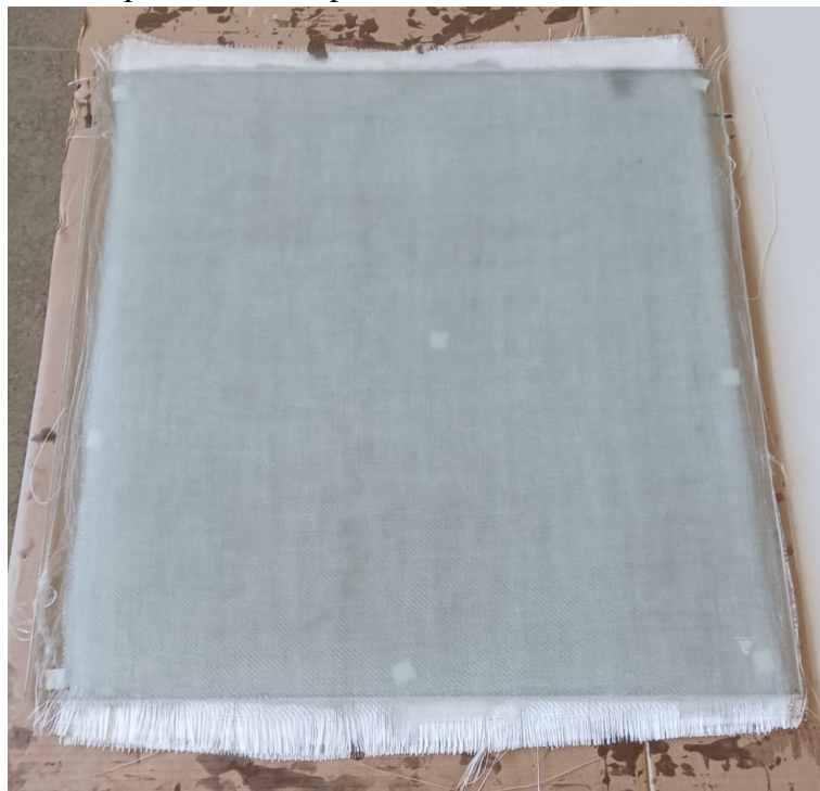
Figura 30 – Placa do compósito obtido após a cura da resina.
