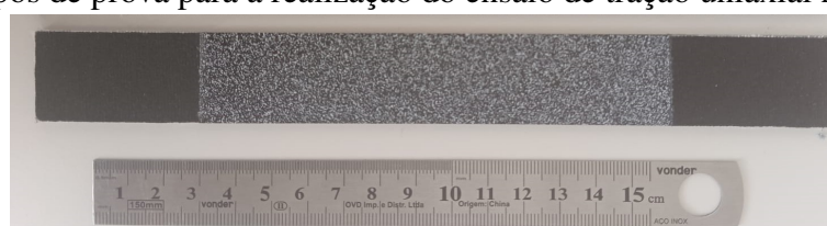
Figura 24 – Corpos de prova para a realização do ensaio de tração uniaxial no LFV.
