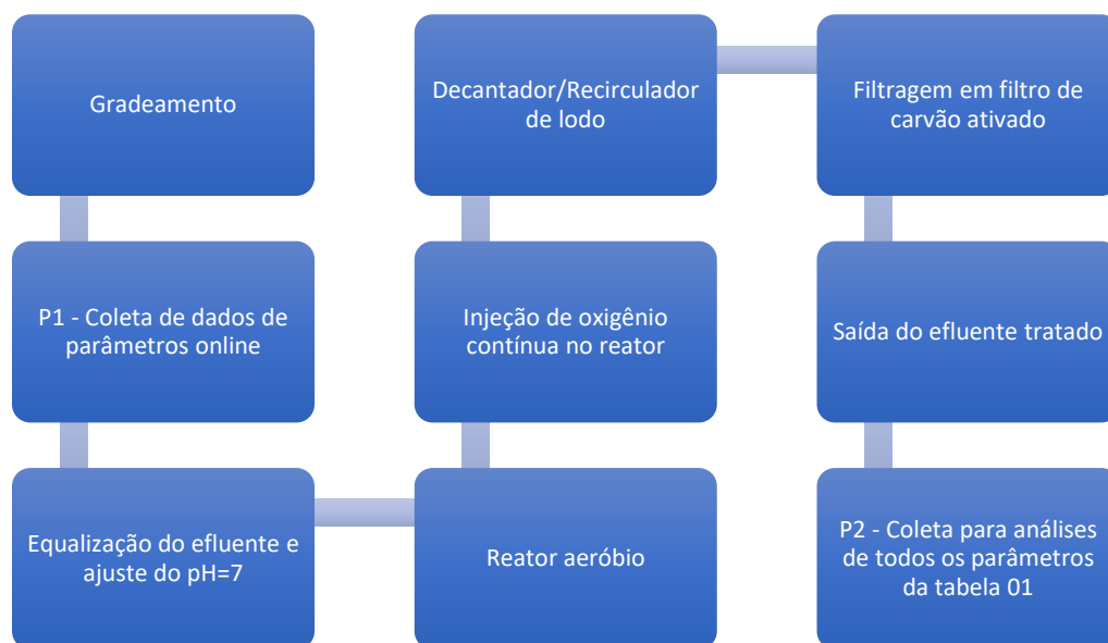
Figura 10 – Fluxograma das etapas do sistema de lodo ativado
