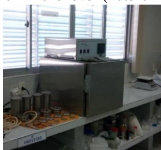
Figura 02 – Roller Oven (Autoria Própria).
