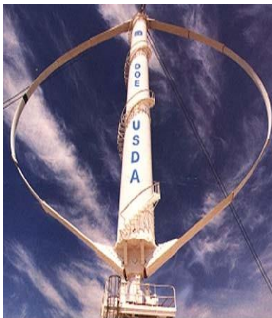
Figura 2 - Aerogerador de eixo vertical
