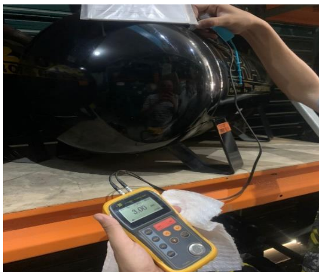
Figura 3- Medição da espessura real da parede do vaso 4 (Autoria própria).
