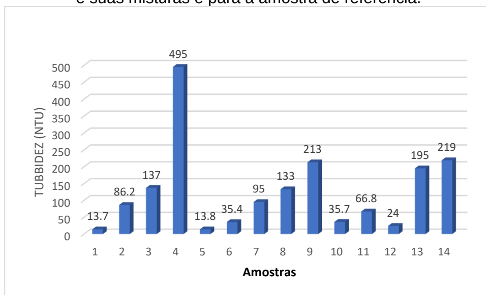
Figura 4 - Análise da turbidez do álcool gel produzidos com diferentes espessantes e suas misturas e para a amostra de referência.
