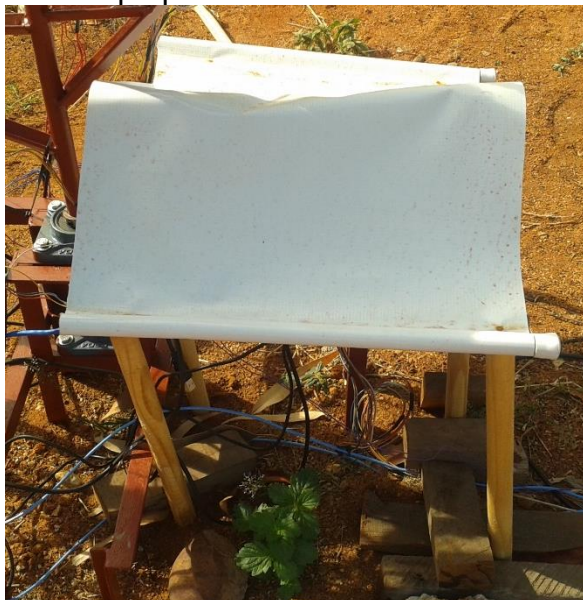
Figura 42 – Capa protetora da caixa do Arduino®
