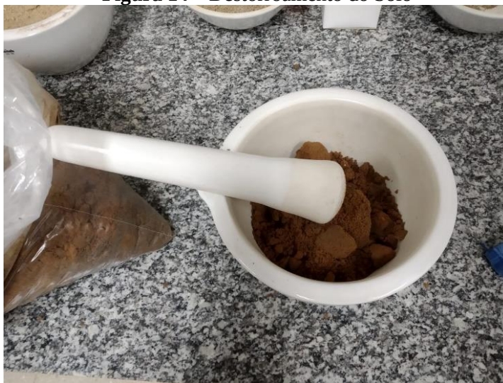
Figura 14 – Destorroamento do Solo
