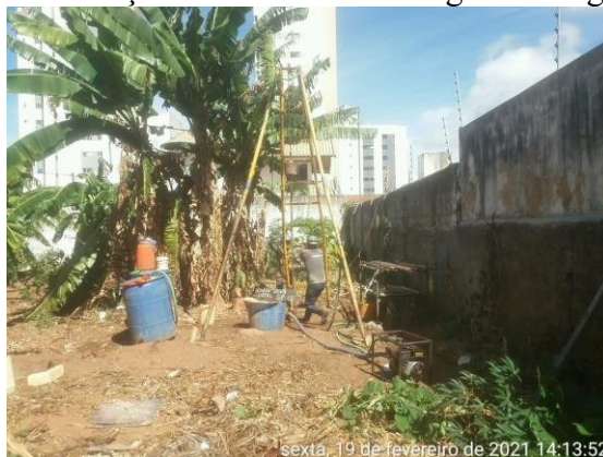
Figura 10 - Execução do ensaio de sondagem do segundo furo.
